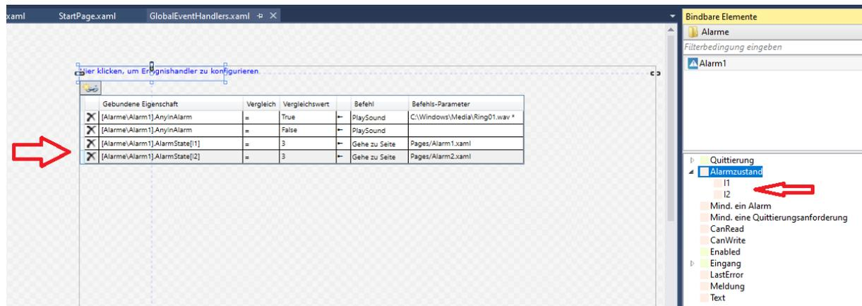
Abbildung 3: Weitere Ereignisse im Ereignishandler für den Sprung auf Alarmseiten bei Alarm
